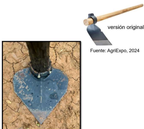
Figura 9. Azada modificada para tener base puntiaguda (versión modificada vs. versión original)
