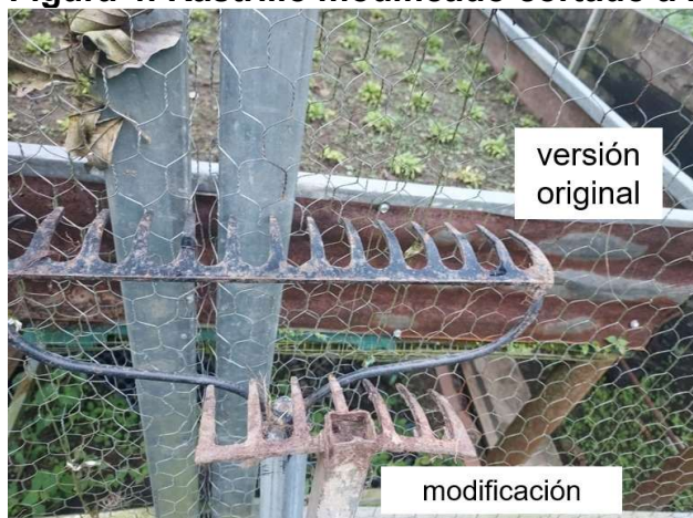
Figura 4. Rastrillo modificado cortado a mitad
